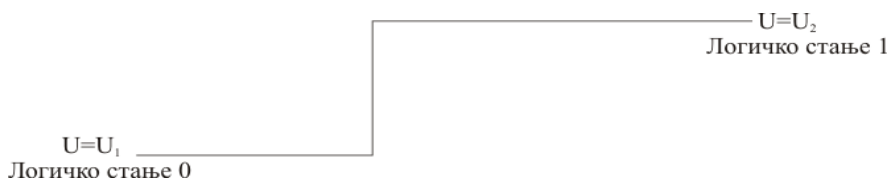
Слика 1. Логичко и физичко стање дигиталног кола
